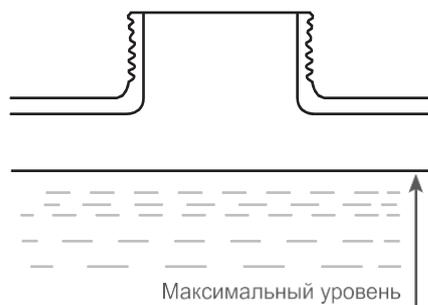
Рис.6 Максимальный уровень топлива в топливном баке
