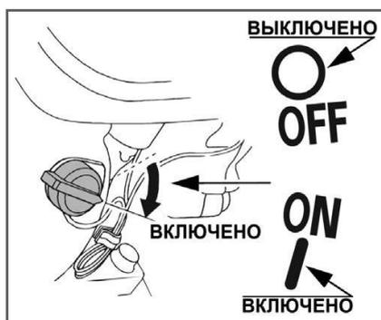
Рис. 12 Выключатель зажигания в положении «Включено»
